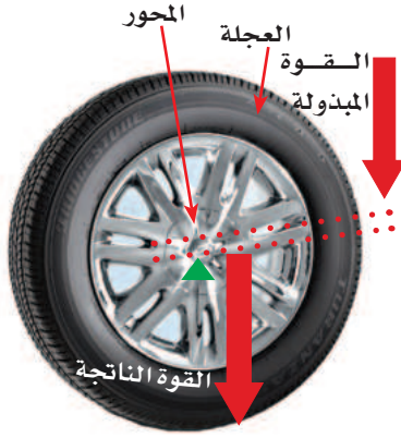
الشكل ٢٢ نصف قطر العجلة أكبر من نصف قطر المحور. ولذلك تكون الفائدة الآلية للعجلة والمحور أكبر من واحد.
